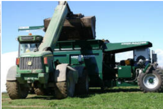
Zdj. nr 5 i 6 urządzenie napełniające rękawy oraz wprowadzające system napowietrzania do rękawów
