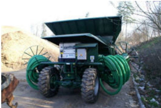
Zdj. nr 5 i 6 urządzenie napełniające rękawy oraz wprowadzające system napowietrzania do rękawów
